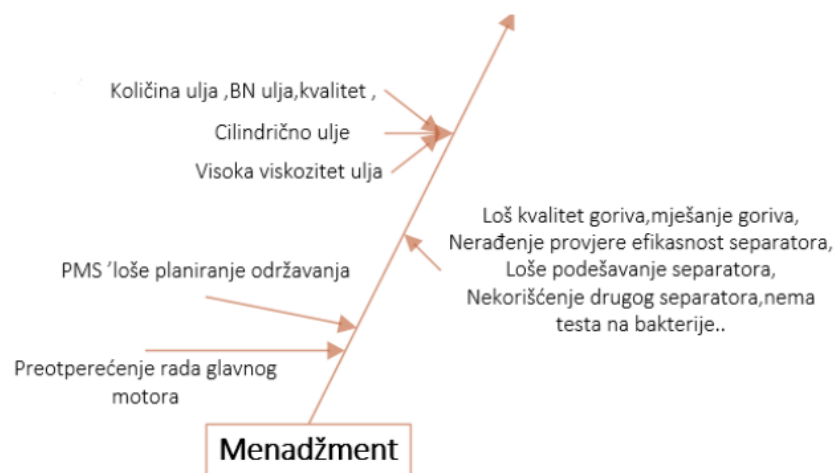
Slika 36. Menadžment (firme ili broda) kao faktor koji utiče na istrošenja klipnih prstenova i košuljice cilindra
