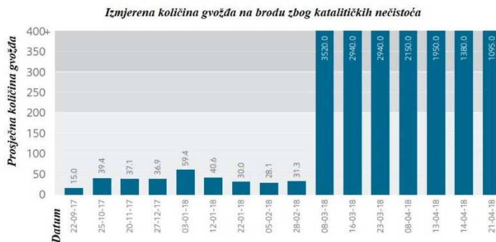
Slika 6. Prikaz povećanja gvožđa u analiziranim uzorcima zbog katalitičkih nečistoća [25]
