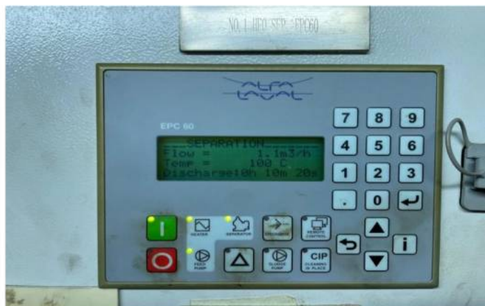
Slika 62. Prikaz podesivog, maksimalno smanjenog protoka kroz separator goriva upotrebom kalibriranih umetaka
