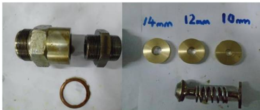
Slika 61. Ventil sa oprugom i kalibrisani metalni umeci za smanjenje protoka nečistog goriva
