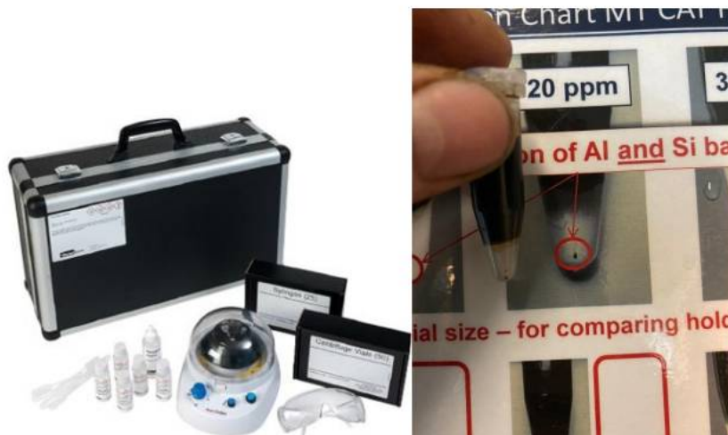
Slika 17. Parker Kittiwake test katalitičkih nečistoća FG - K30566 - KW i prikaz analiziranih rezultata u praksi
